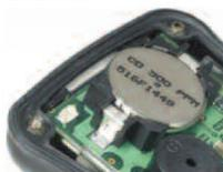
不锈钢结构的MSA专利扭扣式传感器，小巧轻薄，内置固态电解质，有效防止传感器电解液泄漏。氧气传感器为MSA 20L系列。
