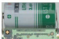
长效耐用的锂电池以及仪表的低功耗设计可以维持仪表两年的工作周期或平均每天2分钟的报警时间，并且在两年期满后根据传感器和电池的实际寿命继续工作。
